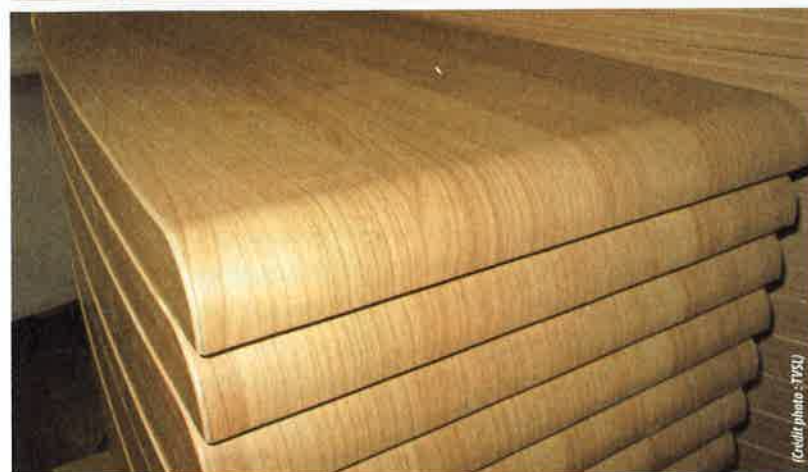
Série de plans usinés et plaqués sur le centre d’usinage Homag BAZ.
