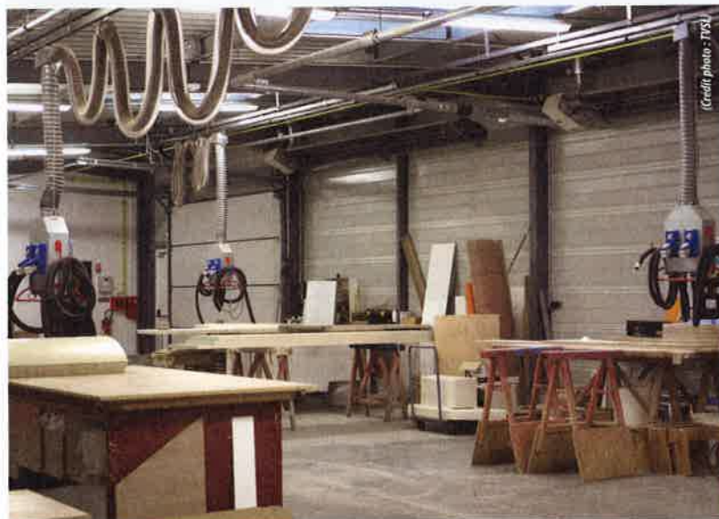
Chaque boîtier multi-énergies, sur lequel sont connectées ponceuses et affleureuses, est facilement amovible grâce à un système sur rails.
